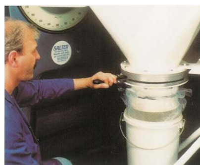
Vanne AD utilisée manuellement pour la pesée de particules fines après tamisage
